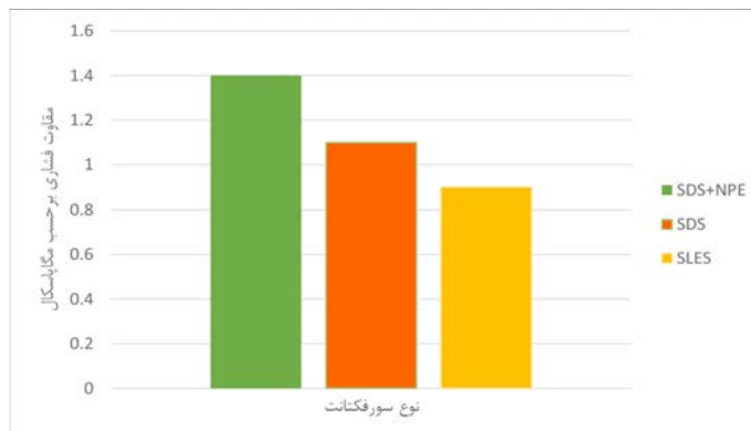
نمودار ۳- مقاومت فشاری نمونه‌های فوم بتن ساخته شده با سورفکتانت‌های SDS، SLES و SDS + NPE
